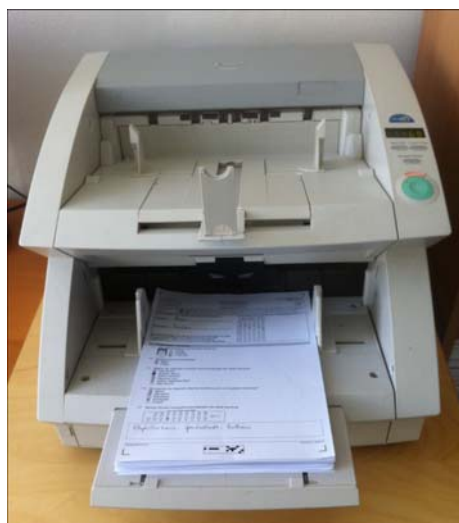
Abbildung 143: Korrektes Einlegen der Prüfungsbögen
